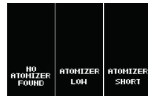
**Atomizer Low Alert:** Lorsque la résistance de l'atomiseur est inférieure à 0,1 ohm en mode VW ou inférieure à 0,05 ohm en modes TC, l'écran OLED affiche "ATOMIZER LOW".
