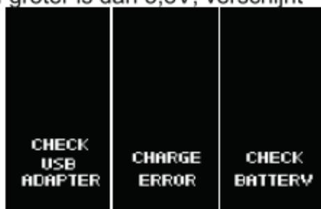
**Foutmelding laden:** Als er geen stroom wordt gedetecteerd in de laadstatus, dan verschijnt er op het OLED-scherm de melding "CHARGE ERROR" [laadfout].
