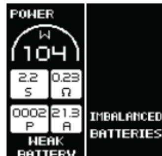
**Waarschuwing geen balans:** Als het verschil tussen de maximum en minimum batterijspanning gelijk of groter is dan 0,3V, verschijnt op het OLED-scherm de melding "IMBALANCED BATTERIES" [Batterijen niet in balans] nadat u de USB-kabel hebt aangesloten. Haal de batterijen eruit om ze op te laden of ze te vervangen door nieuw opgeladen batterijen.
